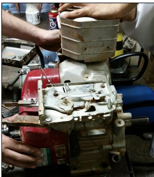
**Figura 23: Motor sem gerador e carburador**
