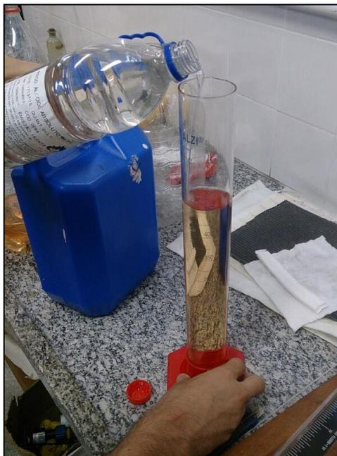
**Figura 53: Adição de álcool Anidro à Gasolina**
