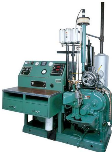
**Figura 17: Motor de determinação do número de octanagem**
