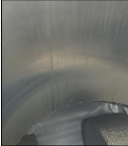
**Figura 33: Marcas verticais no cilindro do motor**
