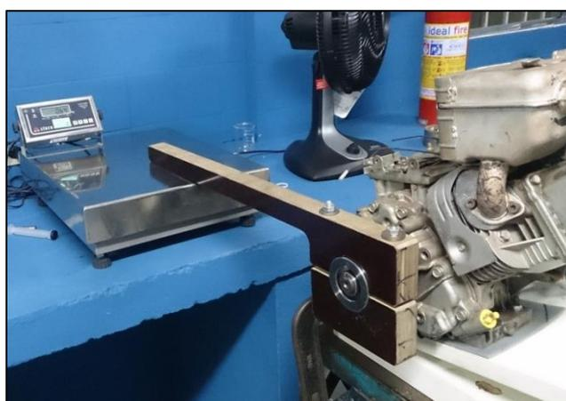
**Figura 45: Montagem do Freio de Prony e bancada**
