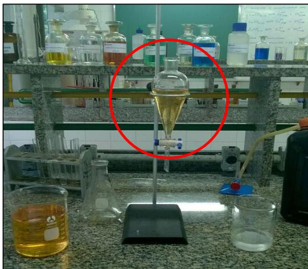
Figura 49: Detalhe do funil de bromo no processo de decantação
