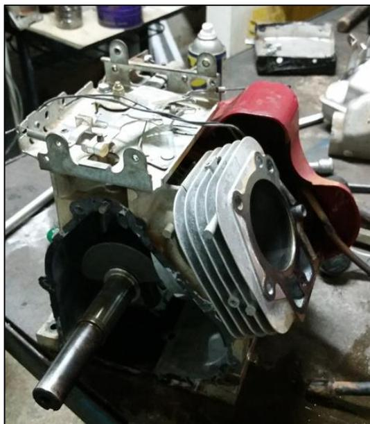
**Figura 27: Desmontagem do Bloco do Motor e Cabeçote**
