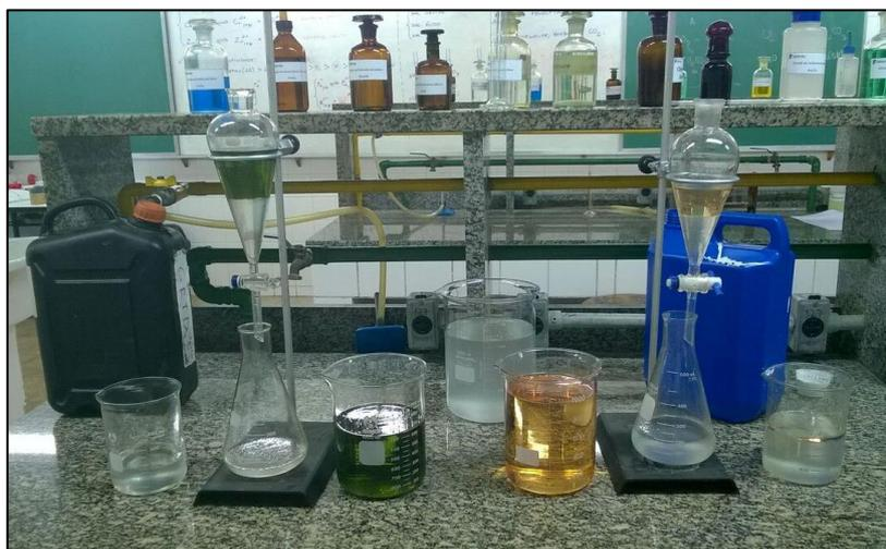
**Figura 52: Processo de retirada da gasolina pura**
