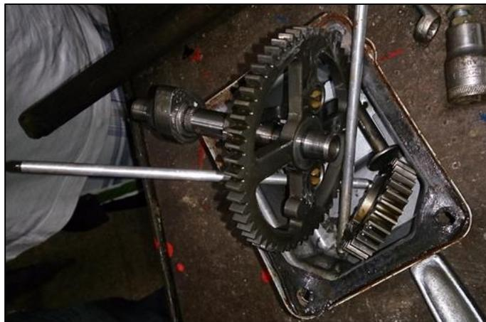
**Figura 28: Componentes da Árvore de Comando**
