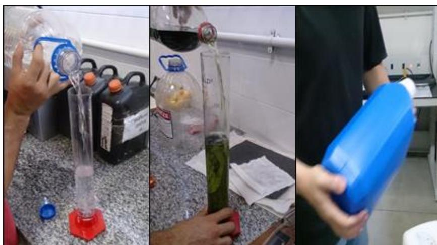
**Figura 51: Processo de Separação do álcool da gasolina**
