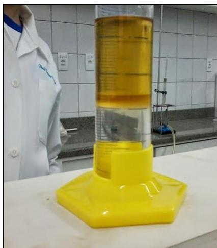
**Figura 50: Gasolina separada do álcool**
