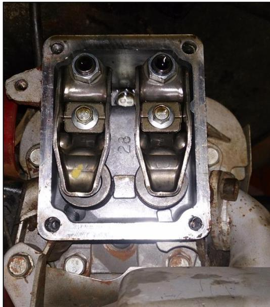
**Figura 25: Detalhe do Interior do Comando de Válvulas**
