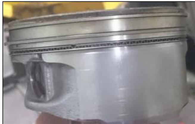
**Figura 31: Detalhe dos anéis de vedação**
