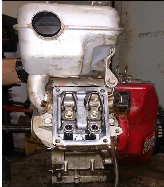
**Figura 24: Desmontagem do Comando de Válvulas**
