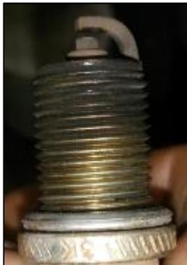
**Figura 26: Vela de Ignição sem sinais de desgaste**
