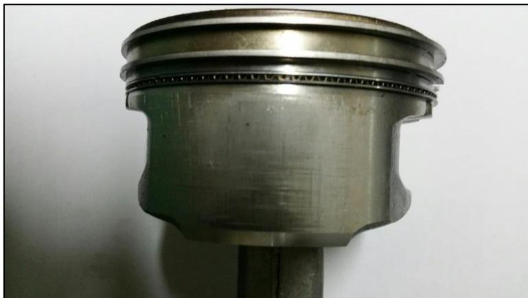
Figura 4: Anéis elásticos
